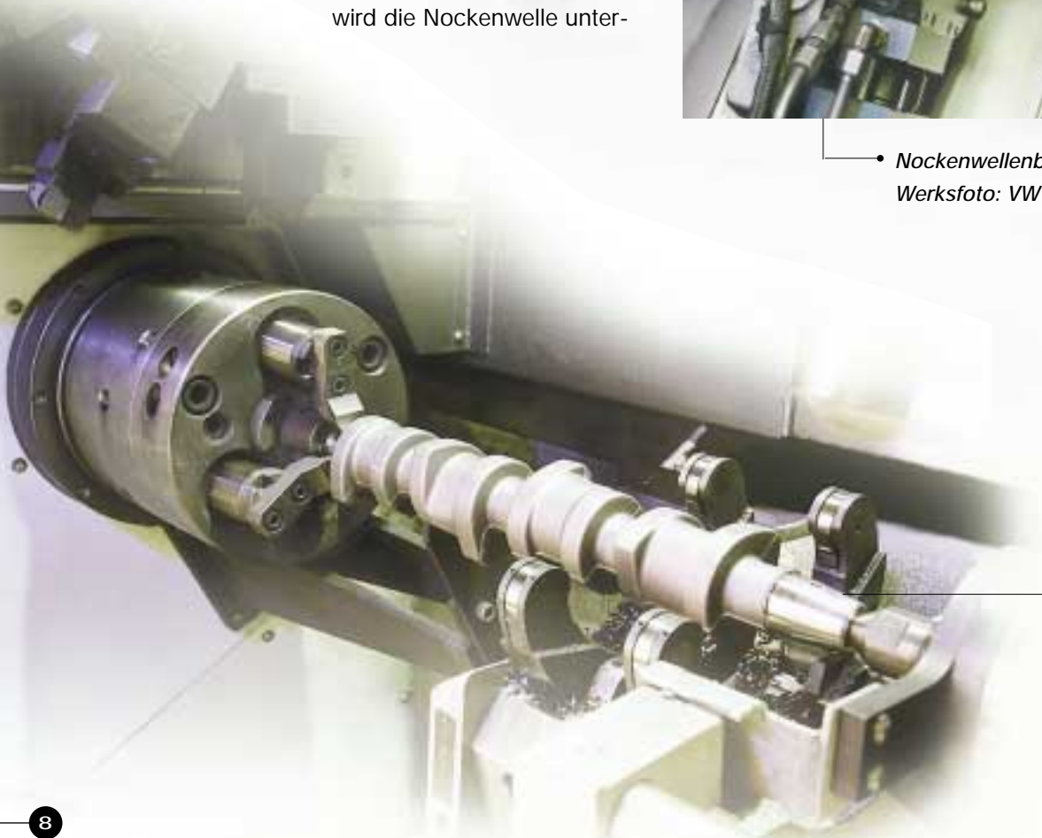
• Teilweise bearbeitete Nockenwelle mit Stütz-lünetten Werksfoto: VW Salzgitter
