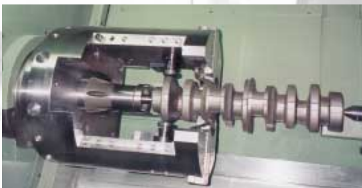
Sonderkonstruktion für LKW-Kurbelwellen sorgt für sichere Werkstückaufnahme und präzise Bearbeitung
