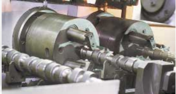
• Hermetisch abgedichtete Spannfüter in einer Fräs- und Bohrbearbeitungslinie
