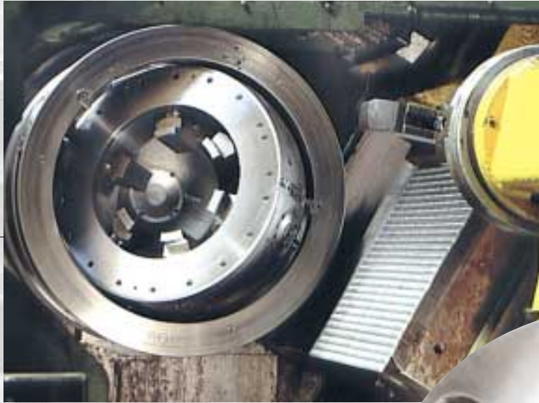
• Hydraulisches Schwenkfutter für die Komplettbearbeitung von Gewindemuffen
