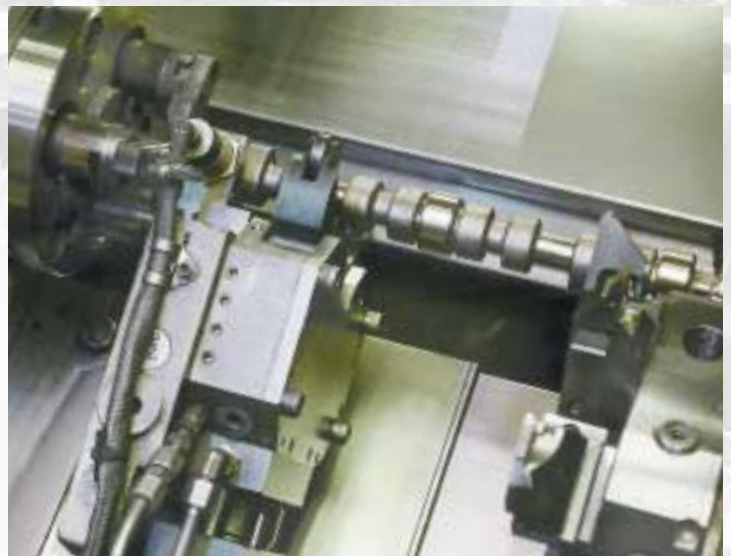
• Nockenwellenbearbeitung mit Stütz-lünette Werksfoto: VW Salzgitter
