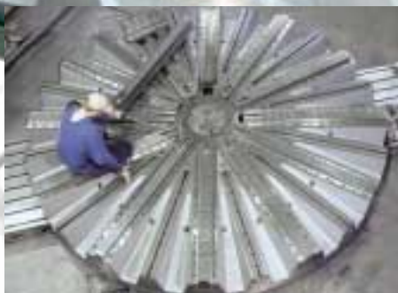
• 12 WAZK 4000 Das größte 12-Backenfutter der Welt mit 4000 mm Durchmesser
